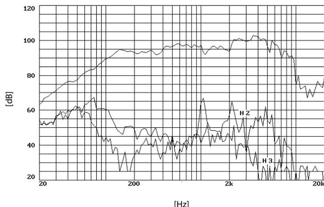
Nota: Respuesta en frecuencia medida en el eje, con el altavoz montado en baffle infinito y en cámara anecoica, 1W @ 1m
