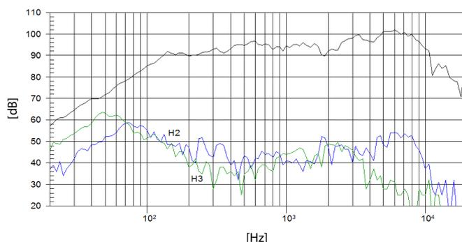
Nota: Respuesta en frecuencia medida en el eje, con el altavoz montado en baffle infinito y en cámara anecoica, 1W @ 1m
